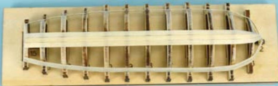
6 Придайте нужную форму переднему концу очередной планки, после чего приклейте ее рядом с верхней планкой, расположенной возле продольной осевой линии.
