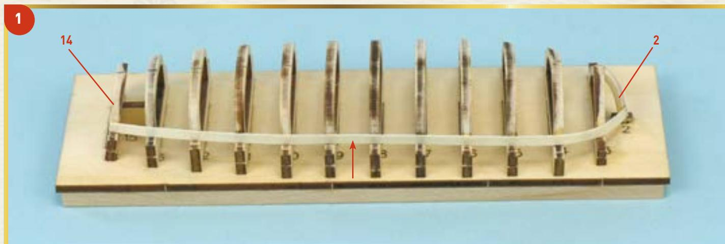
**1** В данном выпуске мы начинаем обшивать каркас корпуса шлюпки, собранный на предыдущем этапе. Подобную работу вы уже выполняли при сборке первой шлюпки. Возьмите одну из планок сечением 0,5 x 3 мм, прилагаемых к данному выпуску, и приклейте ее к левому борту шлюпки над «ступенькой» шпангоутов. На корме обрежьте планку так, чтобы она не выступала за транец 14; на носу обрежьте ее по осевой линии детали 2.
