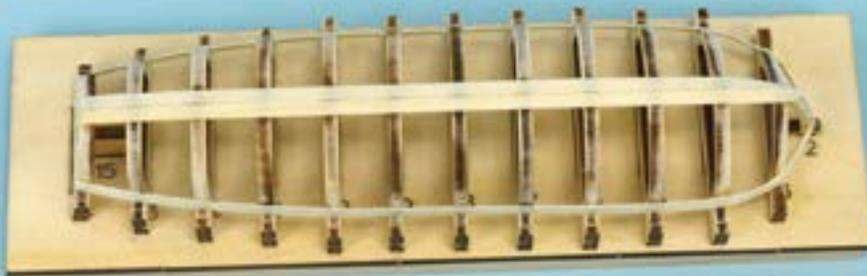
4 Приклейте новую планку с другой стороны продольной осевой линии каркаса, заузив предварительно переднюю часть этой планки так, как вы уже делали в шаге 3.
