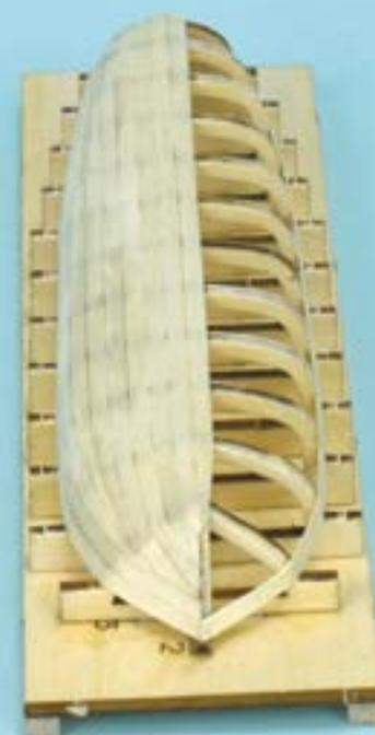
**11** Обрежьте последнюю планку так, чтобы она вошла в оставшийся зазор, после чего приклейте ее к каркасу. На этом вы закончили обшивку левого борта шлюпки.
